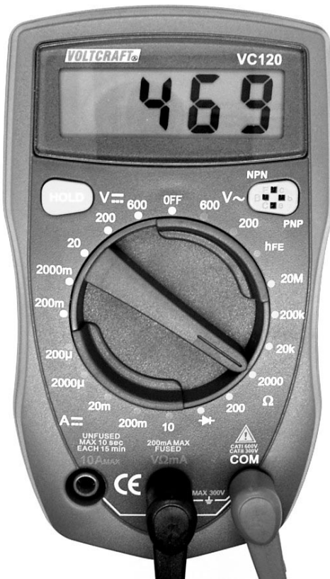
Abb. 9.8: Messung an einem Widerstand mit 470\ \Omega
