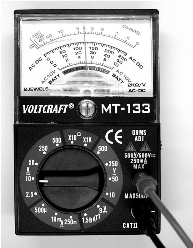
Abb. 9.2: Spannungsmessung im 10-V-Bereich
