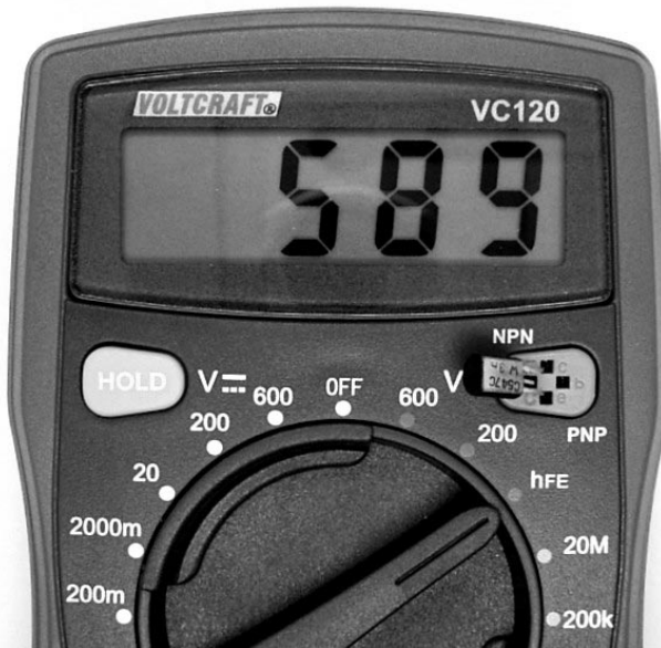
Abb. 9.12: Messung der Stromverstärkung h_{FE}
