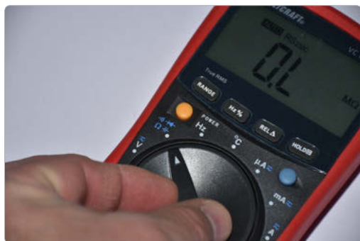
Bild 3.10: Zum Ermitteln von Widerständen ist das Multimeter in den Ohm-Messbereich ( \Omega ) zu schalten.
