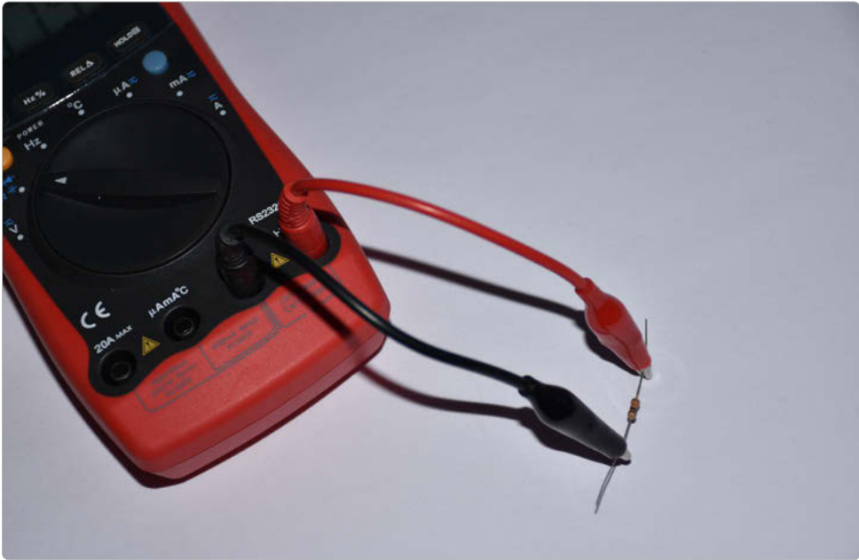
Bild 3.11: Hier wurde der Widerstand mit zwei Krokoklemmen an das Messinstrument angeschlossen.
