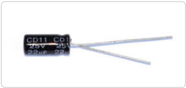
Bild 2.23: Bei diesem Elektrolytkondensator ist die Kapazität in Klartext (22 µF) aufgedruckt.
