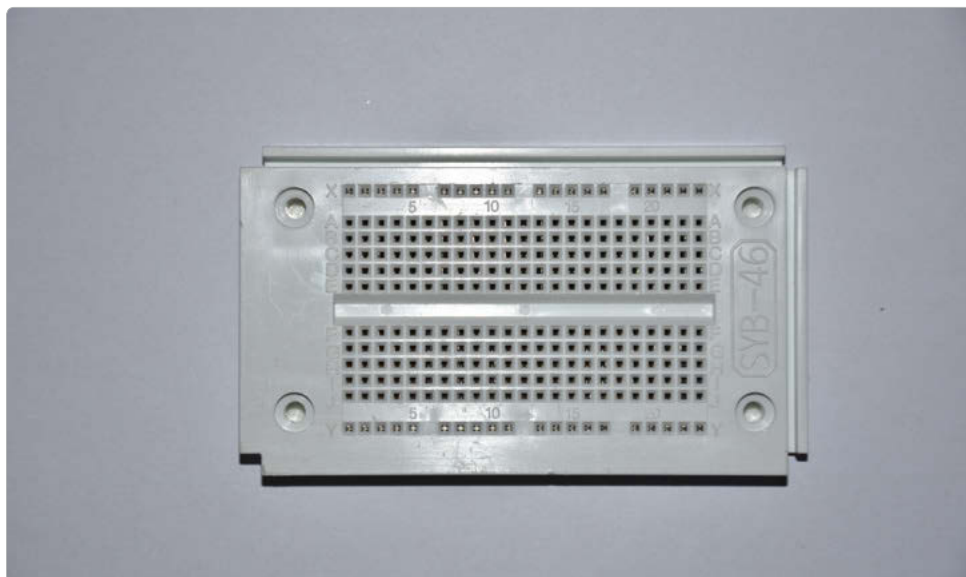
Bild 5.1: Steckboards erlauben das schnelle Aufbauen von Schaltungen.
