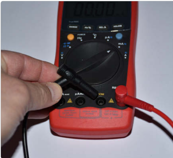
Bild 3.4: Die Messstrippen sind je nach gewünschter Messung in die dafür erforderlichen Buchsen zu stecken.
