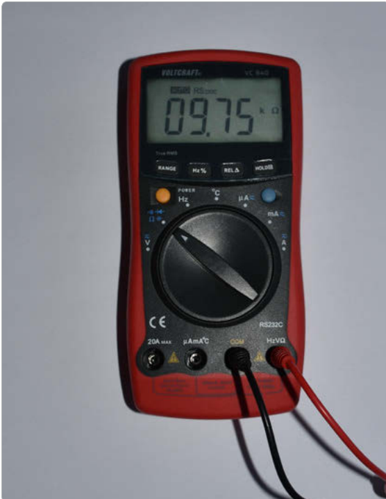
Bild 3.11: Hier wurde der Widerstand mit zwei Krokoklemmen an das Messinstrument angeschlossen.
