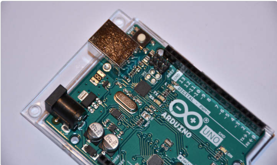
Bild 2.75: SMD-Bauteile sind mitunter so klein, dass sie in ihren Details nur noch schwer mit bloßem Auge zu erkennen sind.
