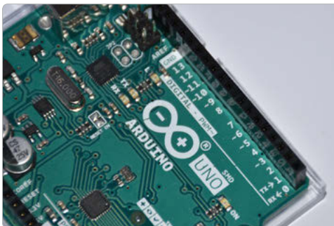
Bild 7.24: Die Digitalpins 3, 5, 6 und 9 bis 11 des Arduino Uno unterstützen PWM. Sie sind mit einer Wellenlinie markiert.
