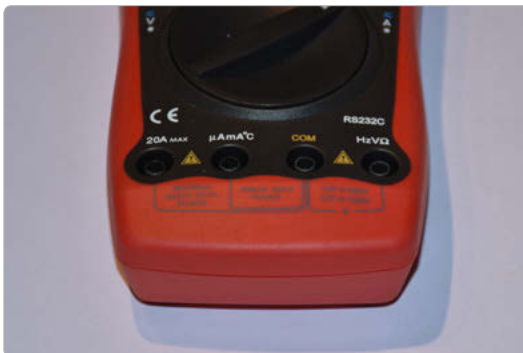
Bild 3.3: Dieses Messgerät ist CAT-III-zertifiziert und kann für Messungen bis zu Spannungen von 1.000 V genutzt werden.
