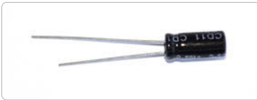
Bild 2.21: Der Pluspol eines Elektrolytkondensators besitzt einen längeren Anschlussdraht.
