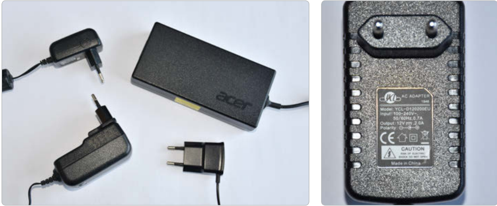
Bild 2.65: Netzteile gehören zu unserem Alltag. In ihnen sind größere oder kleinere Transformatoren und Gleichrichter eingebaut. Das Typenschild der Netzteile verrät, auf welche Spannung die 230 V aus der Steckdose umgewandelt werden. Hier sind es 12 V.
