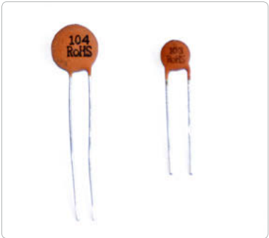
Bild 2.24: Auf diesen Keramikkondensatoren ist die Kapazität mit einem dreistelligen Zahlencode angegeben.
