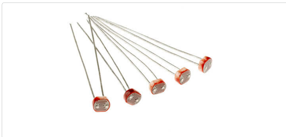
Bild 2.13: Fotowiderstände ändern ihren Widerstandswert mit der Lichthelligkeit.
