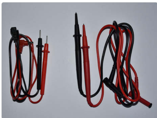
Bild 3.1: Vergleich zwischen minderwertigen Messleitungen eines billigen (links) und eines hochwertigen Multimeters (rechts).
