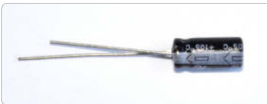
Bild 2.22: Zuverlässiger ist die Kennzeichnung des Minuspols direkt am Gehäuse.
