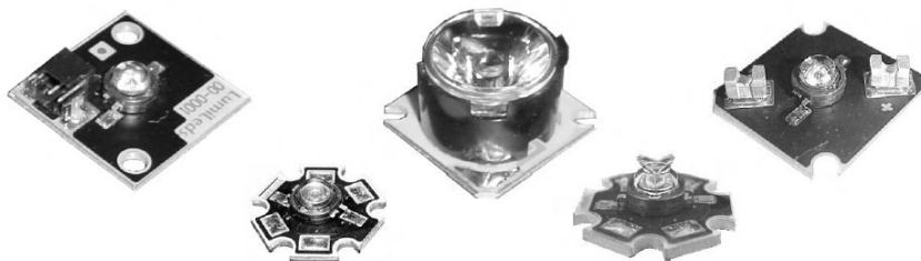
Abb. 8.3 Auf Kühlbleche vormontierte Luxeon-Emitter
