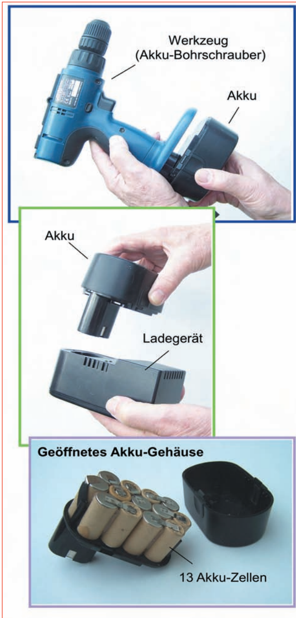
Abb. 13.8 – Einige Akkuwerkzeuge sind mit einem abnehmbaren Akkuteil ausgelegt.
