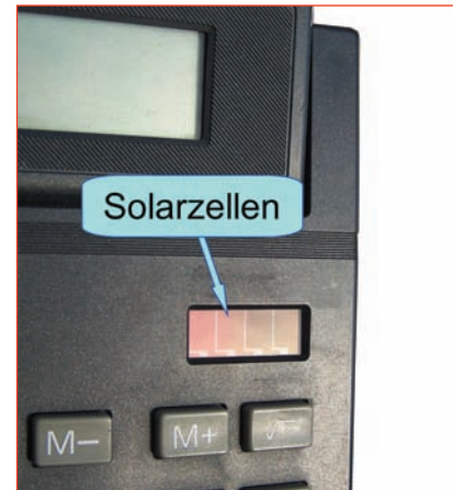
Abb. 9.6 – Dünnschicht-Solarzellen aus ausgedienten Taschenrechnern können für das Nachladen von Gold-Caps verwendet werden, die Kleingeräte mit niedrigem Energieverbrauch versorgen.
