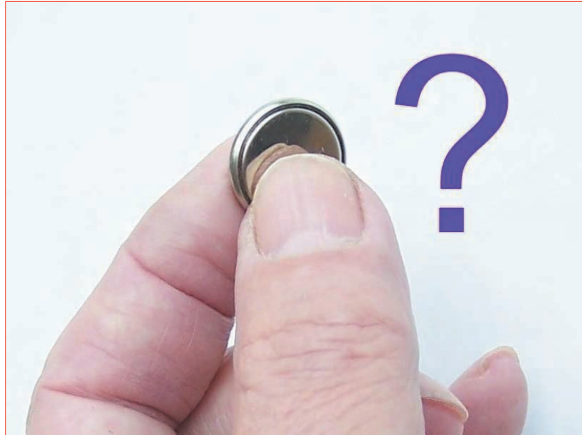
Abb. 5.1 – Wer feuchte Hände hat, sollte eine Knopfzelle nicht wie abgebildet mit den Fingern halten: Wird die Zelle mit zwei Fingern einer Hand kurzgeschlossen, wirkt es wie der Anschluss eines Verbrauchers, der die Zelle entlädt.
