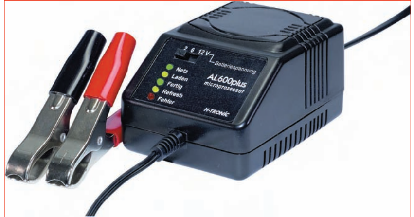
Abb. 13.13 – Ausführungsbeispiel des Ladegeräts AL 600 PLUS für das Laden praktisch aller Sorten von Bleiakkus mit Nennspannungen von 2, 6 und 12 Volt und mit einem Ladestrom von maximal 0,6 A: Das Gerät verfügt über Diagnosefunktion, Defekterkennung und Überladeschutz und ist auch für Erhaltungsladung von Akkus vorgesehen, die z. B. im Winter außer Betrieb sind (Foto/Anbieter: Reichelt Electronic).
