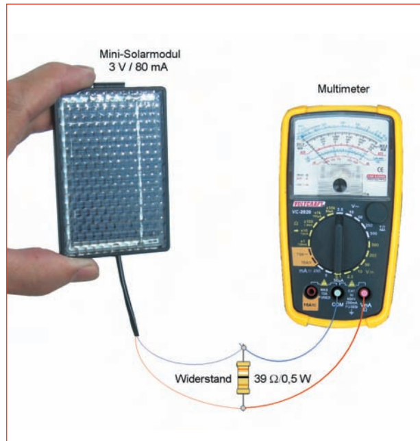
Abb. 14.9 – Ein Widerstand als „Belastung“ am Ausgang von Solar-Modulen oder gekapselten Solarzellen ermöglicht eine Ermittlung ihrer Belichtungsabhängigkeit mit einem Voltmeter: Die Ausgangsspannung variiert mit der Belichtung (unbelastete Solarzellen reagieren auf Änderungen der Belichtung nicht brauchbar, da in dem Fall nur die Leerlaufspannung angezeigt wird).
